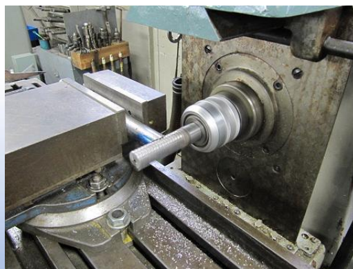
パイプすり合わせ
