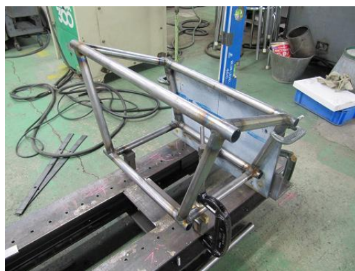
リアセクション最後部据え付け
