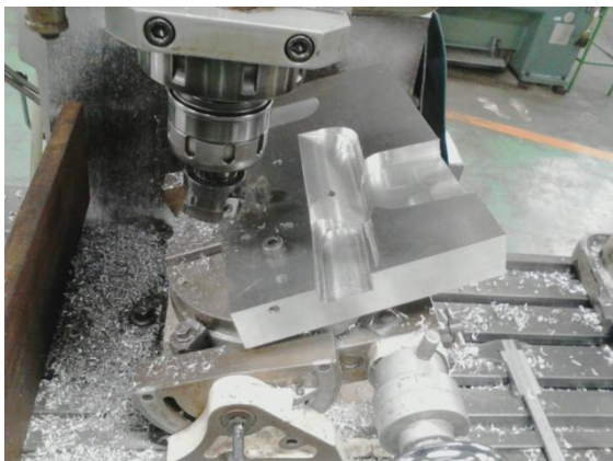
(図2：サーキュラーテーブルを使った加工の様子)
