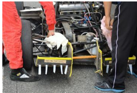
損傷したディフューザー
