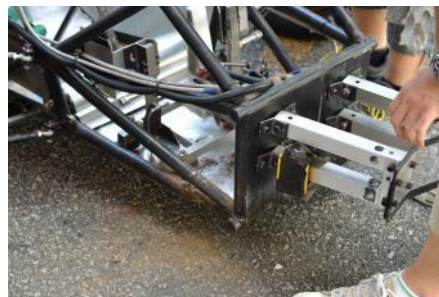
損傷したインパクトアッテネータ
