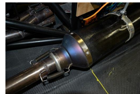
耐久走行の熱で青く焼けたサイレンサ
