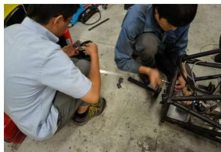
修理中のアッテネータ締結部
