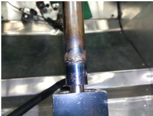
図8：破断したコラムシャフト
