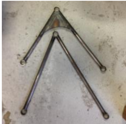
Fig2 : 溶接が完了した A アーム
