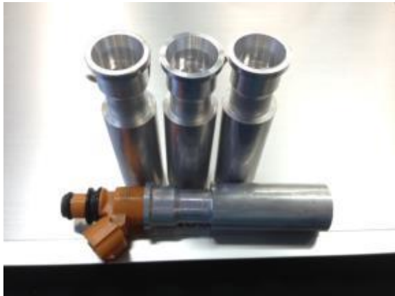
Fig7:インジェクタマウント製作途中
