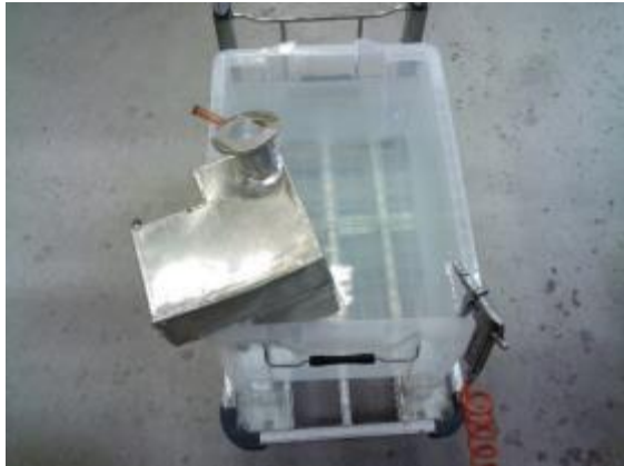
Fig17:コンプレッサーのエアを使用した漏れチェック
