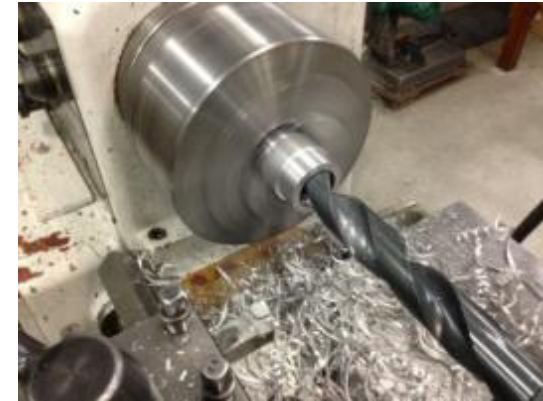
Fig2:工場の旋盤を利用し、ボトムインレット切削
