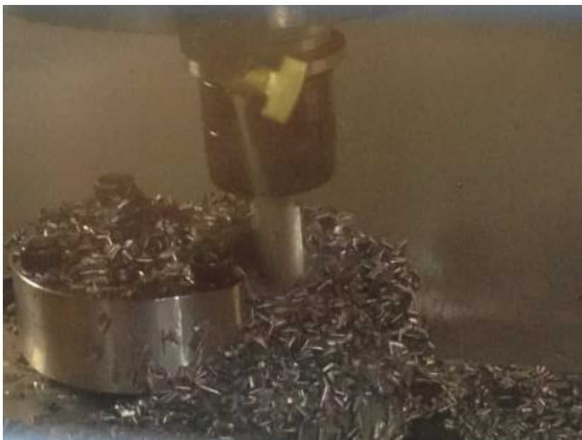
Fig1 : マシニングセンターを用いたフロントハブの製作
