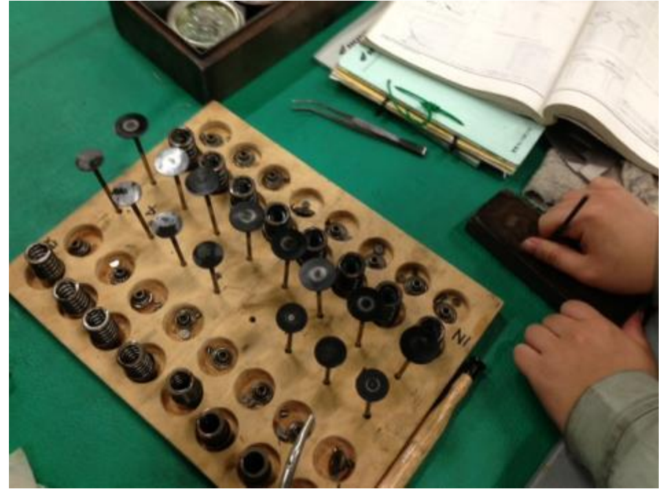
Fig3:オイルストーンを使ったバルブのすず取り
