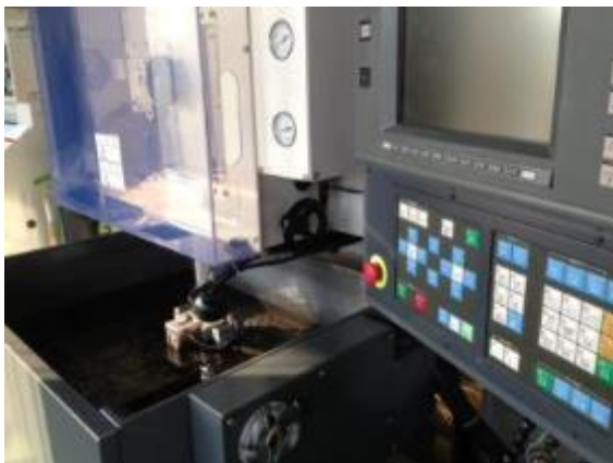
Fig12:高精度 AI ワイヤークット放電加工機
