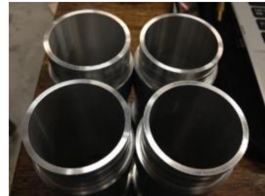
Fig3:NC 旋盤を用いて \Phi 40 から \Phi 38.5 のテーパ加工を施しました。
