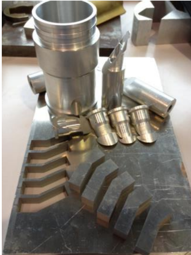
Fig9:インジェクタマウント・フューエルレールマウント製作途中 弊校の TECC (Techno Creation Center) に高精度 AI ワイヤークット放電加工機を用いてインジェクタマウント、フューエルレールマウントの製作を致しました。
