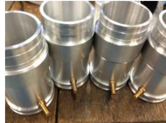
Fig11:負圧センサ取り付け
