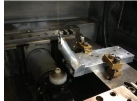
Fig10:インジェクタマウント加工の様子
