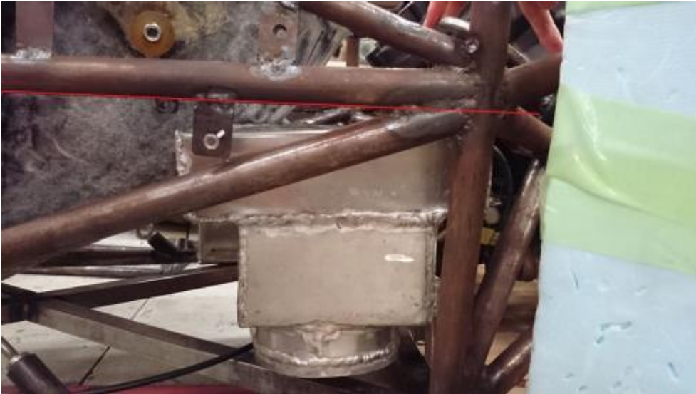
Fig3:車両組み付け時改良版燃料タンク
