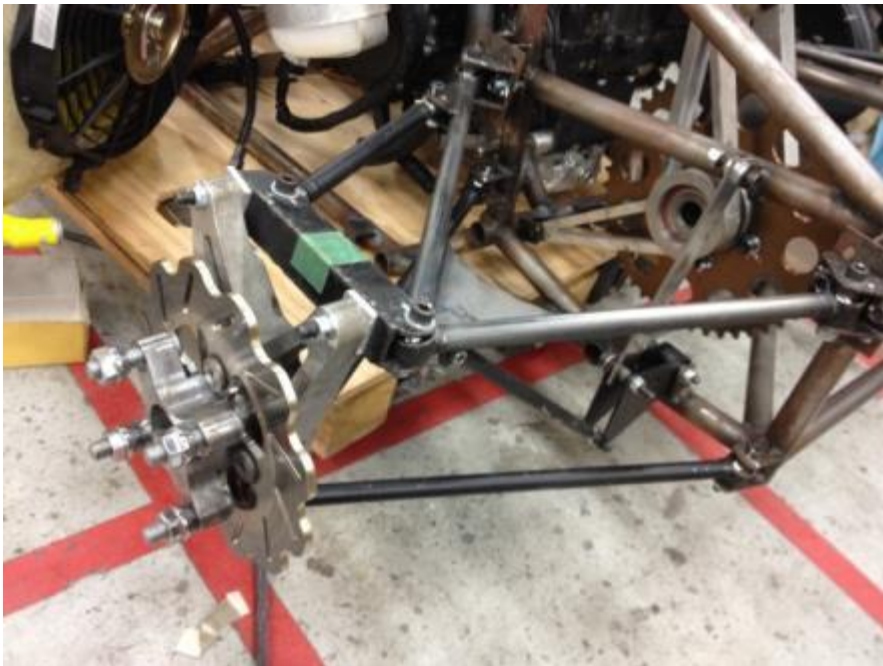
Fig1.組み付けられたリアセクション
