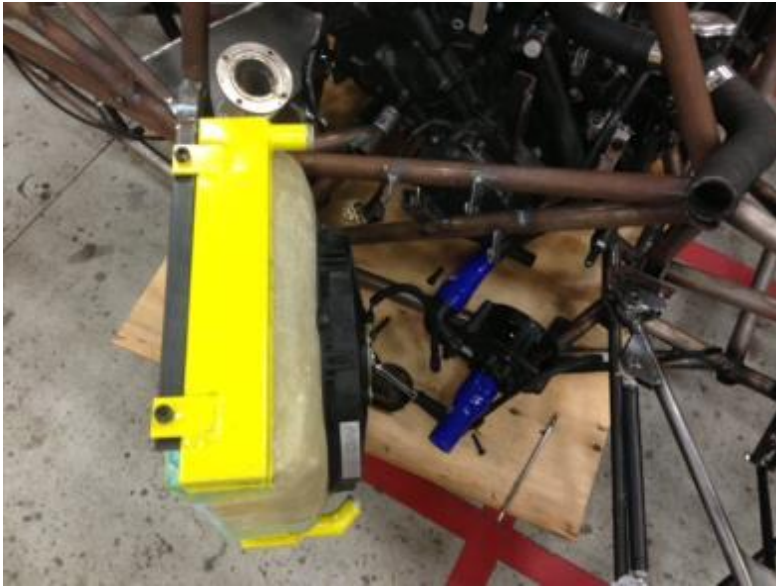
Fig1:ラジエーターステイの再溶接と電動ウォーターポンプ
