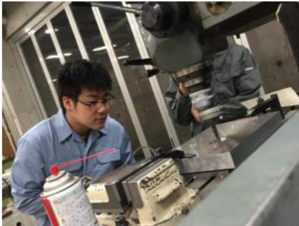
Fig.5 ボーリングヘッドを用いた製作
