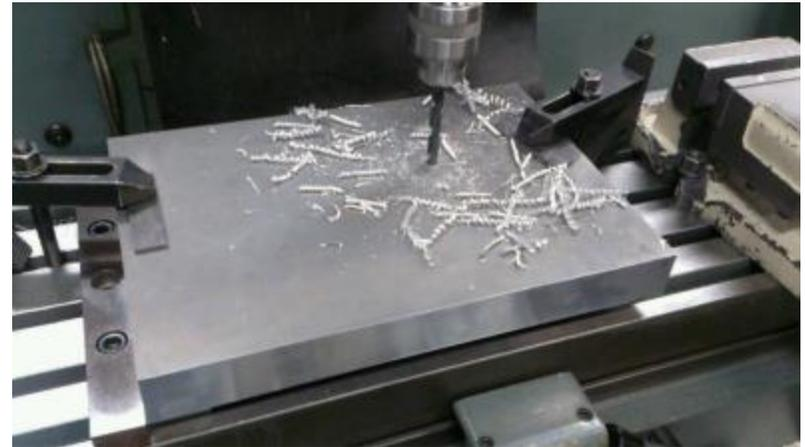
Fig.2 アップライトへの下穴加工
