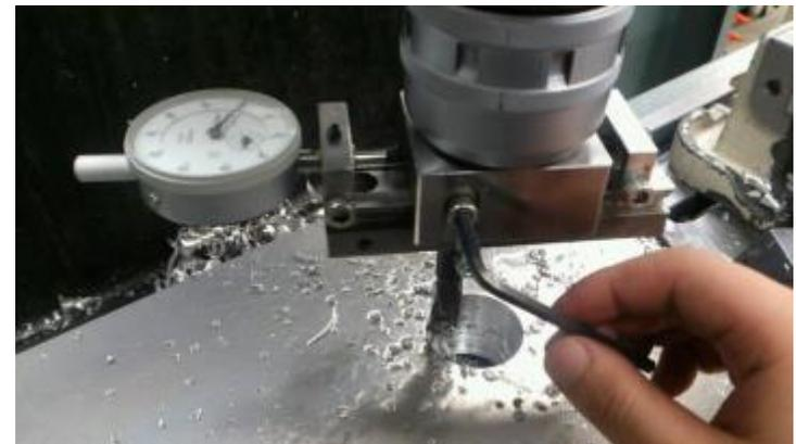
Fig.3 ボーリングヘッドのセッティング
