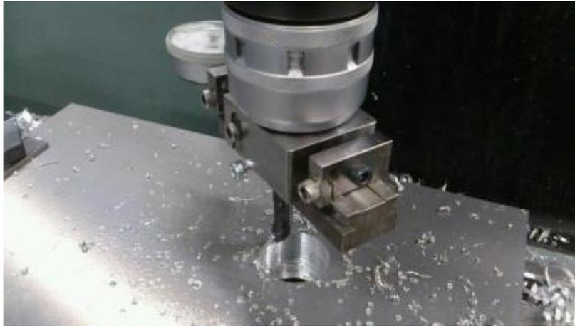
Fig.4 ボーリングヘッドを用いたアップライトの切削
