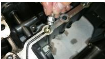
Fig.9 ガスケットが詰まっていた流路
