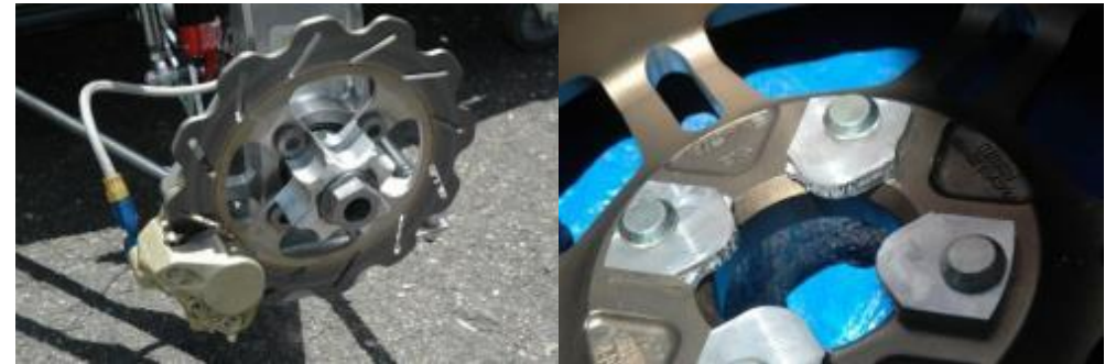
Fig.2 破断したハブ(車体側)
