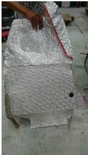
Fig.1 完成したファイヤーウォール
