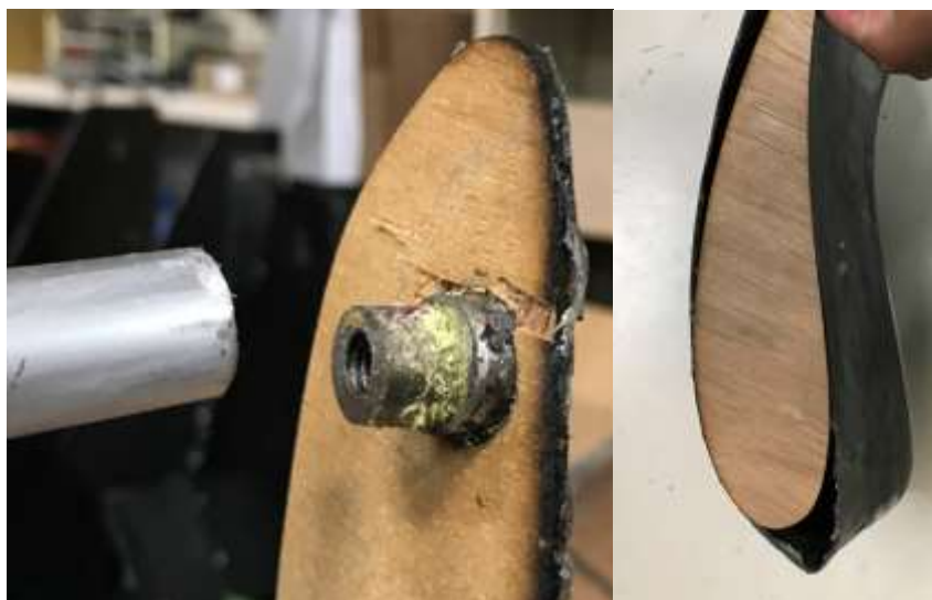
図3 左:リブ破損部分 右:木型と翼形
