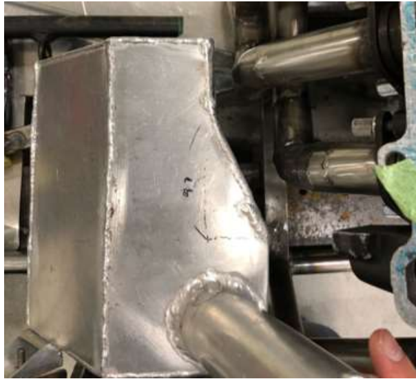
図1 カット後の燃料タンクの画像
