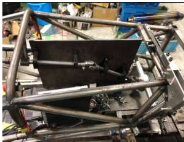
図7 製作時のステアリングシステム
