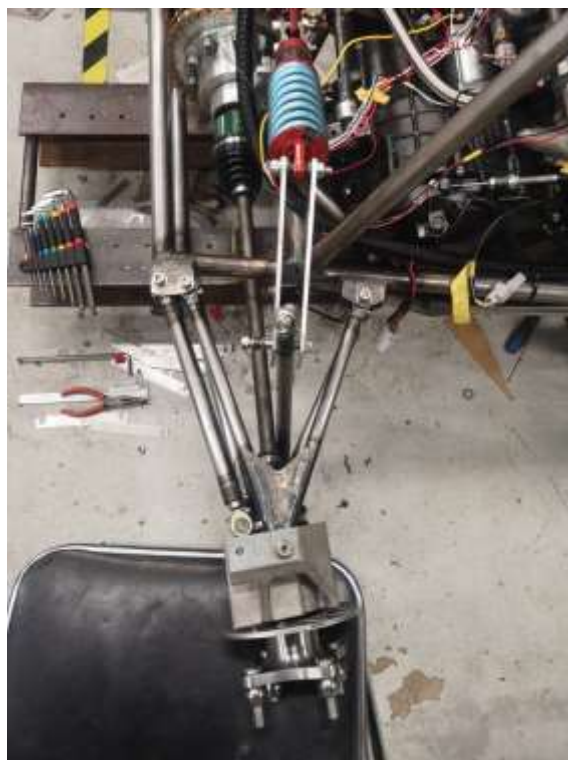
図5 ロアアームとプッシュロッドの干渉写真
