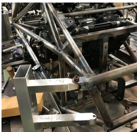
Fig. 10 リアAアームブラケット溶接の様子
