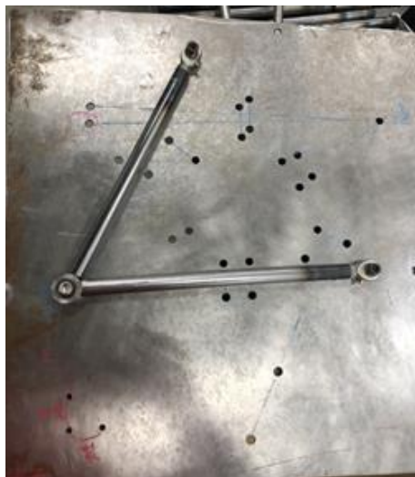
Fig. 19 製作中の A-arm と治具
