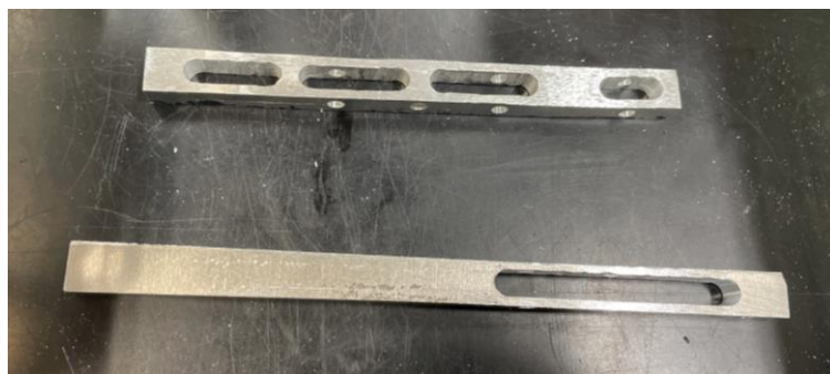
Fig. 15 フライス加工後のシフター・クラッチの軸部（上:シフター 下:クラッチ）
