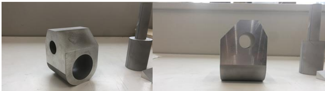
Fig.12 ワイヤー放電加工後のハウジングボックス
