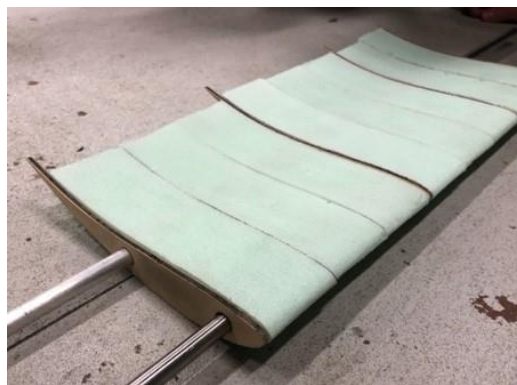
Fig. 21 心材、リブ、スパーのアセンブリ (翼の内部構造)
