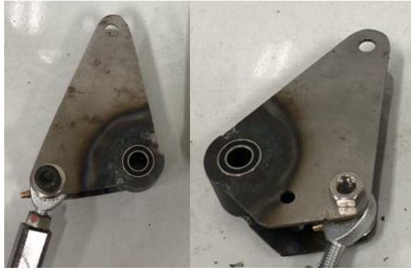
Fig. 17 ベルクランクリア (左) とフロント (右)
