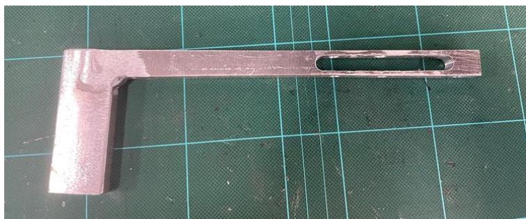
Fig. 16 溶接加工後のクラッチ
