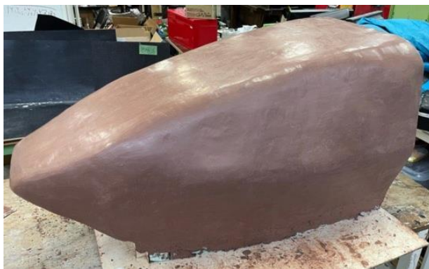
Fig. 13 Body 雄型 クレイモデル
