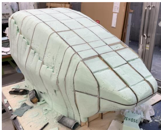
Fig. 12 Body 雄型 ミラフォームを引き詰めた状態
