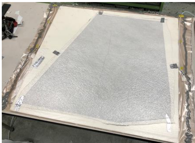
Fig. 15 リアウイング翼端板積層準備、真空引き
