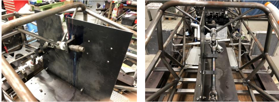
Fig. 6 コラムシャフトステアの溶接
