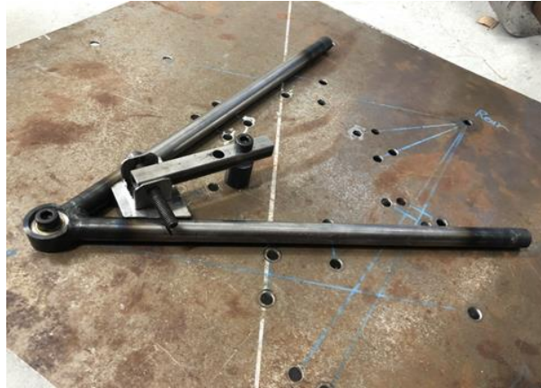
Fig. 9 フロント A-arm とプッシュロッドの溶接
