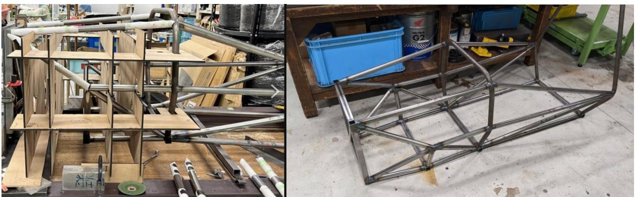
Fig.7 フロントセクション治具(左) フレームフロントセクション溶接(右)
