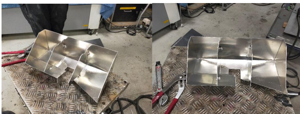
Fig.2 バッフルプレートの取り付け
