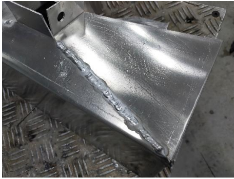
Fig.3 燃料タンクの溶接
