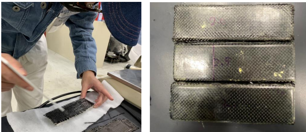
Fig.20 試験片作成の様子（左）完成した試験片（右）
