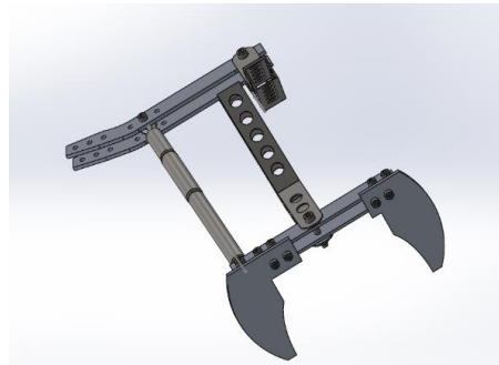
Fig.14 圧力センサーを導入したシフターの全体形状（ワイヤーなし）
