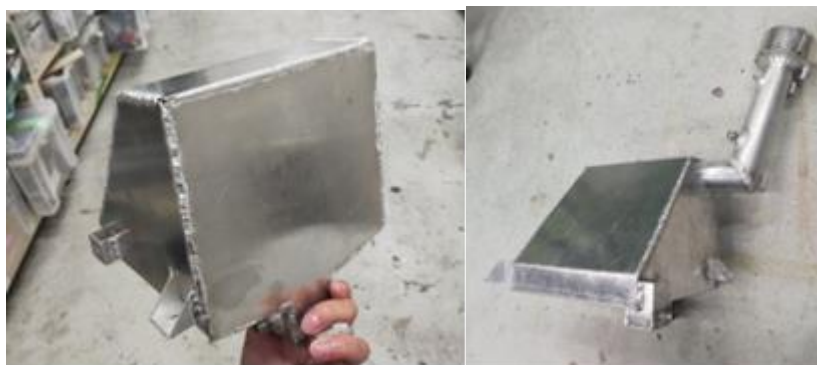
Fig2. 燃料タンク外観
