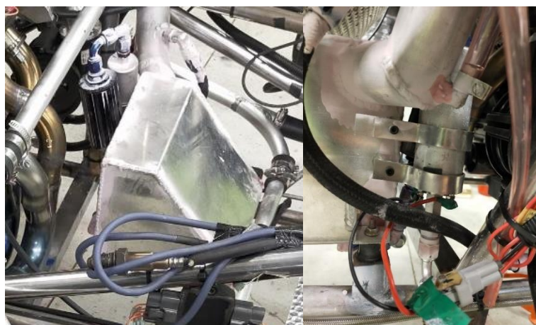
Fig. 燃料ライン取り付け外観
