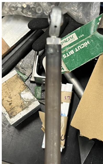
Fig. Rear サイドロッドのボールジョイントねじ部の折れ
