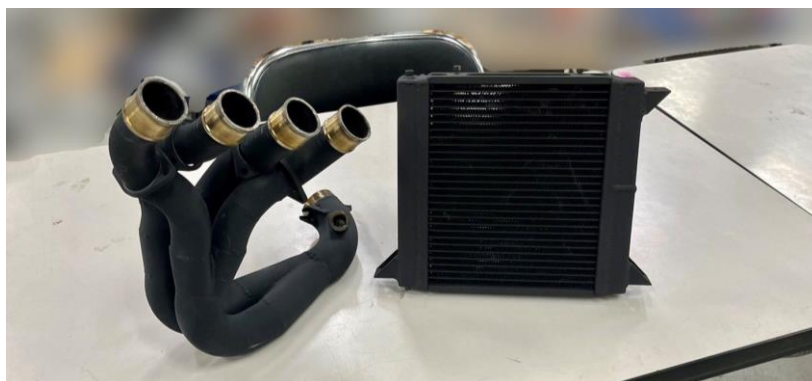
Fig.1 施工後のエキゾーストマニフォールドとラジエーター
