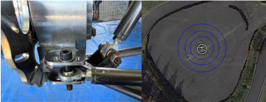
Fig6. 左：アッカーマン率変化のためのタイロッドブラケット 右：3種類の定常円コース
