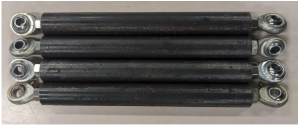
Fig. 5 製作したダミーダンパー
