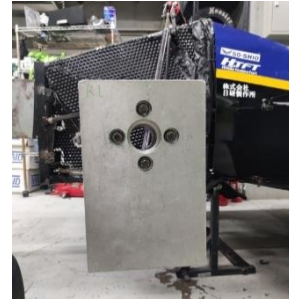
Fig. 6 製作したダミーホイール
