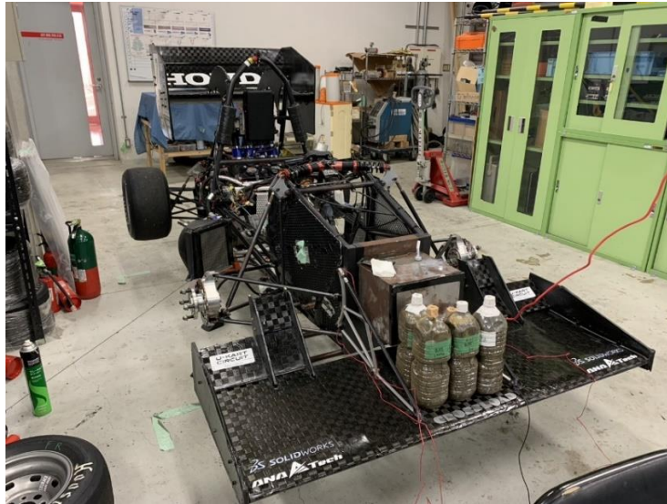
Fig22. ひずみゲージでの実測の様子
