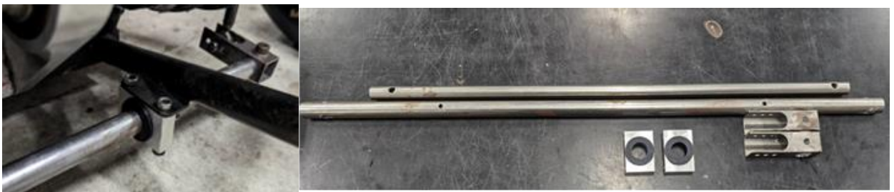
Fig22. (左図) 取り付けの様子 (右図) 新たに制作したスタビライザー
