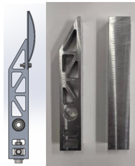
Fig.17 ペダル支柱（左：設計 右：製作）
