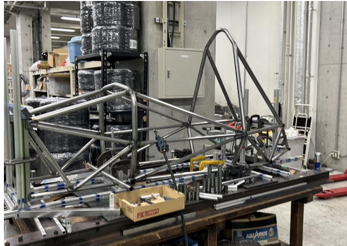
Fig.10 点付けが終了したフレーム
