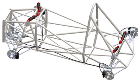
Fig.18 ブレーキラインの配置・測定
