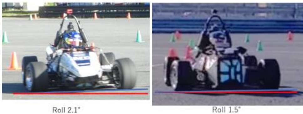
Fig.11 スタビライザー変更によるロール変化 (左：大会時 右：試走時)
