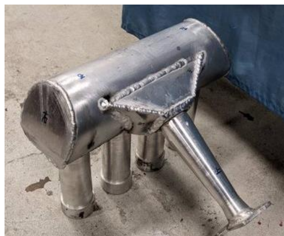
Fig.4 完成したアルミ吸気
