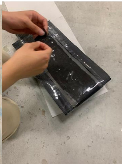
図〇 翼の積層試験片
