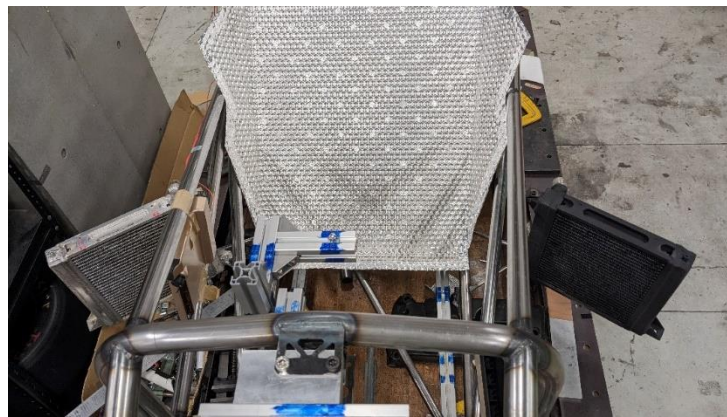
Fig.7 ラジエーター取り付け
