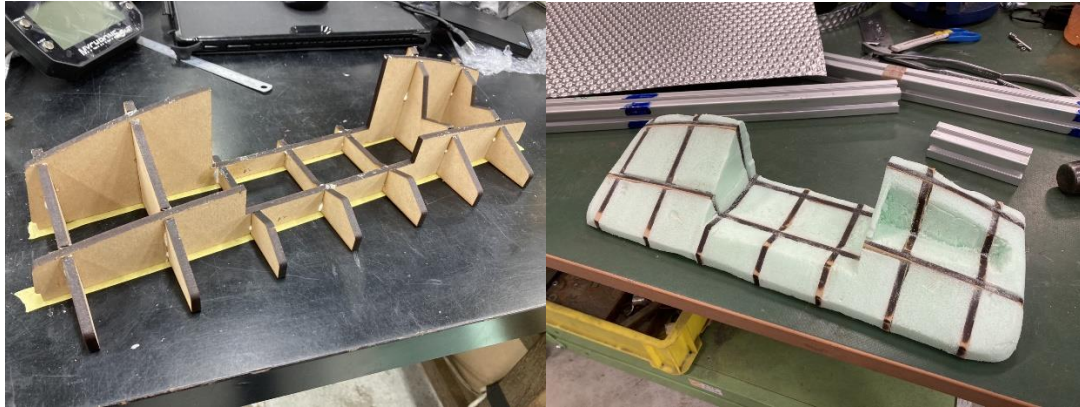
Fig.9 ダッシュパネル製作用型
