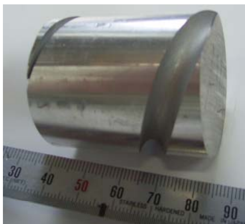
図16 溝深さ変化スパイラル溝加工サンプル
