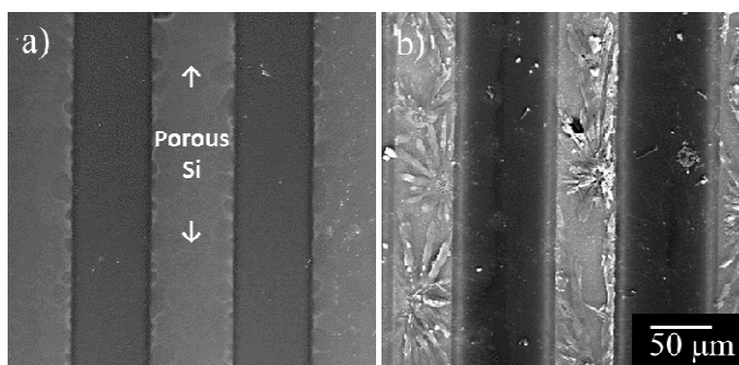
図1 (a) ライン状に形成したポーラスシリコンの表面SEM像(電解条件 HF:IPA=1:2, 50 mA cm -2 , 90s), (b) HAp処理後の同試料の表面SEM像
