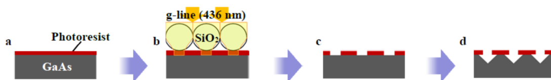
図 1 GaAs の化学エッチングのプロセス (a) GaAs 基板上へのフォトレジストの塗布, (b) フォトレジスト上に展開した SiO 2 微粒子を介しての露光, (c) 現像処理によるフォトレジスト製マスクの作製, (d) 化学エッチングによるピットアレイの作製
