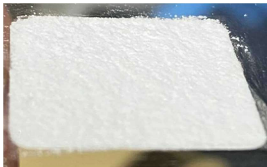
図 2-19 \text{CaF}_2 粉末にし, XRD 試料台に配置した外観
