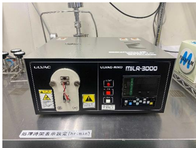
図 2-10 アニール処理装置（ULVAC-RIKO, MILA-3000）の外観 11)
