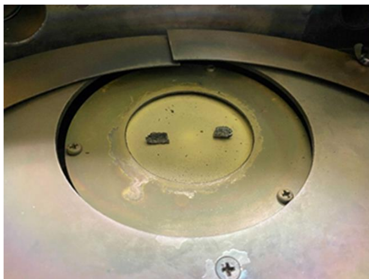
図 2-9 \text{In}_2\text{O}_3 ターゲット上の B ペレット配置の様子 11)
