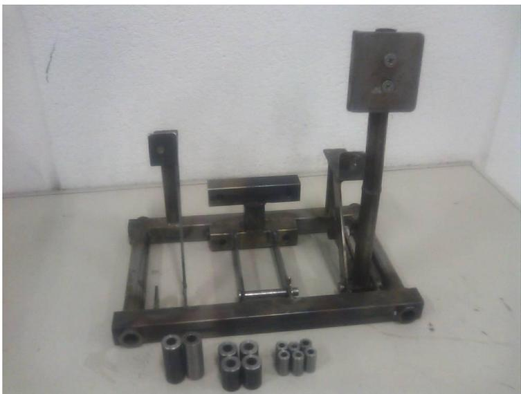
10年度ペダルと11年度ペダルの部品です。11年度ペダルは踏み板の角度調節が可能になります。
