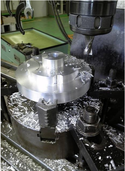
↑フライス盤によるハブの切削
