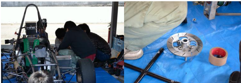
リアを確認するメンバー（左図）と取り出したハブ（右図）
