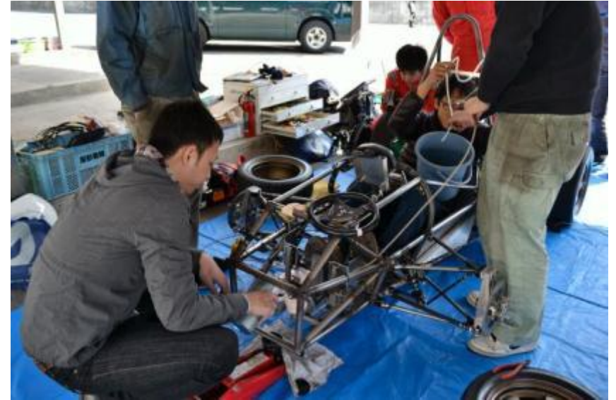
図：エア抜き作業風景
