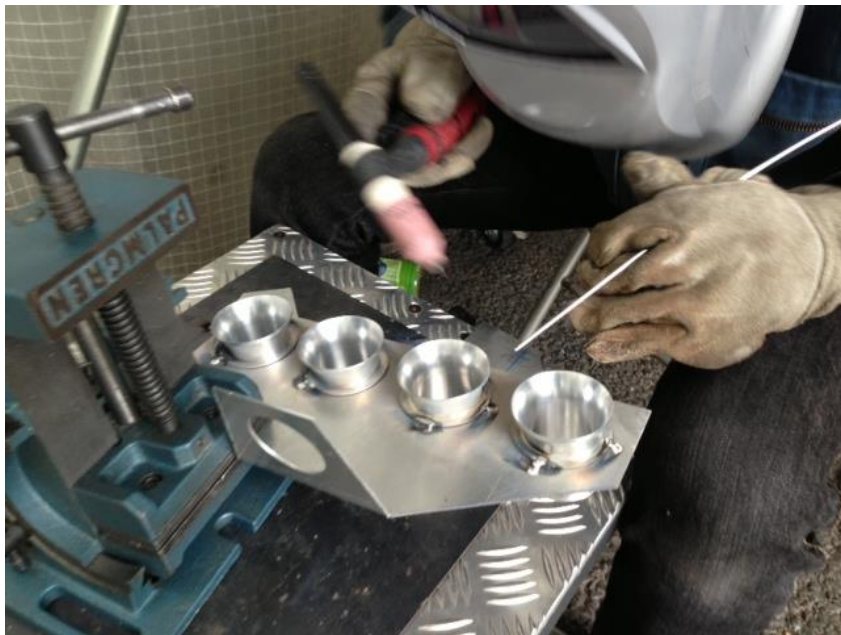
<写真 9> インテークの溶接風景
