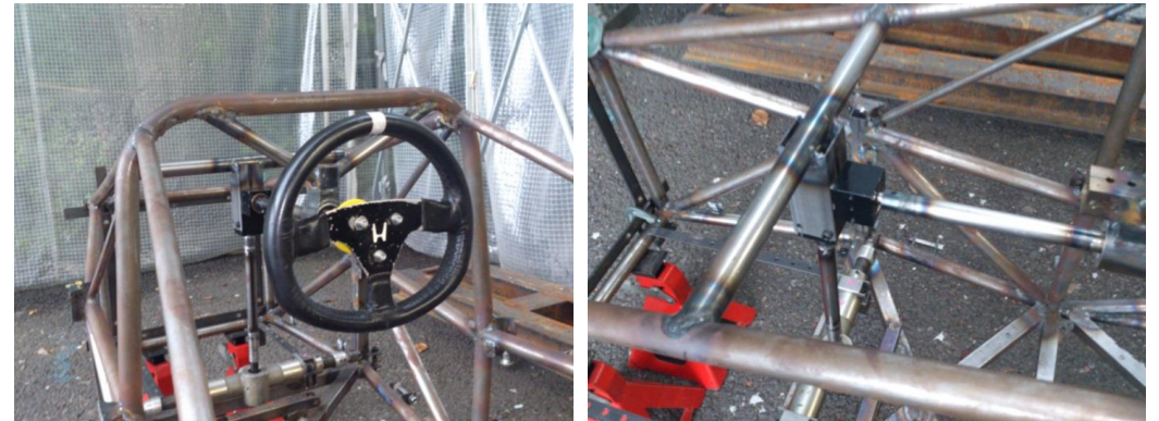
<写真 7、8> 新型のステアリングシステム
