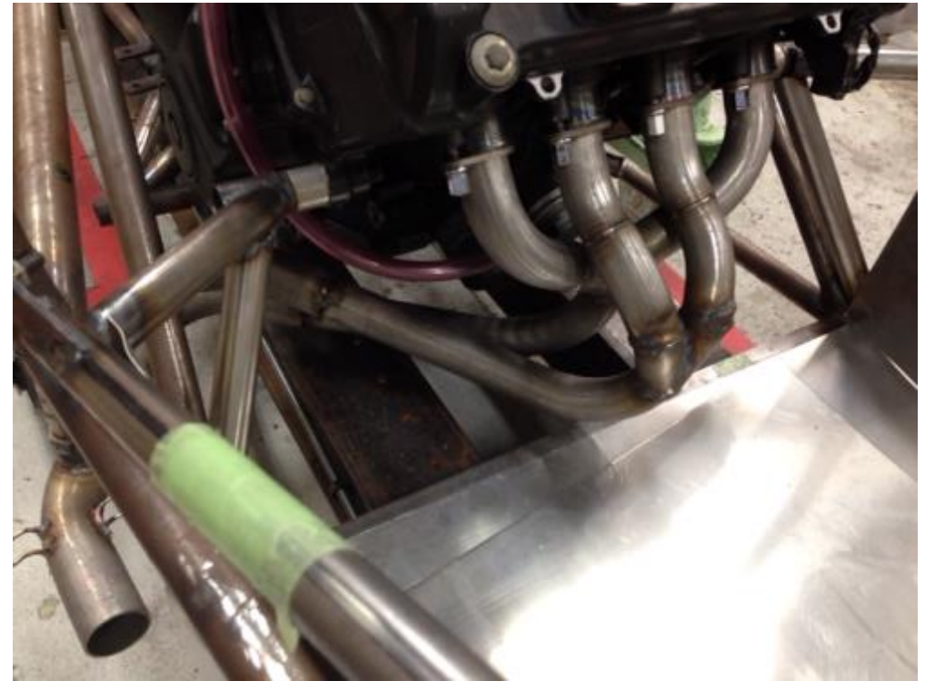
Fig4:Exhaust 完成品②
