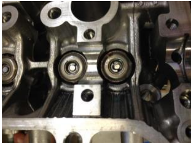
Fig.8 コッターが上手くはまっていなくバルブが下がっている
