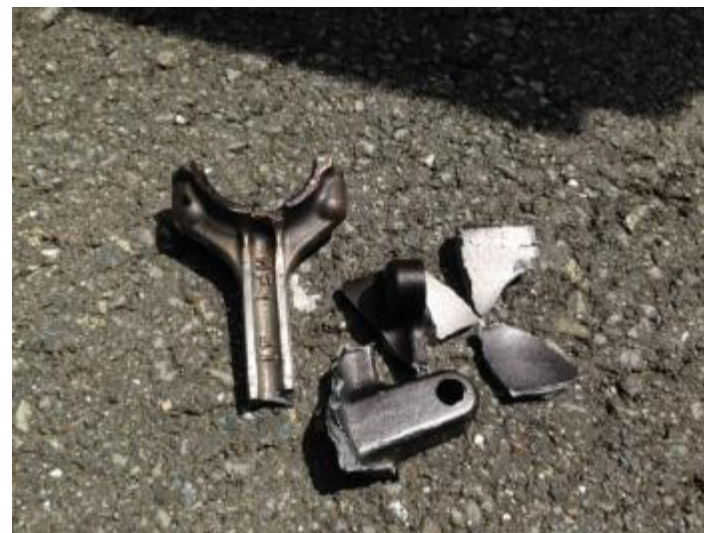
破損したコンロッド
