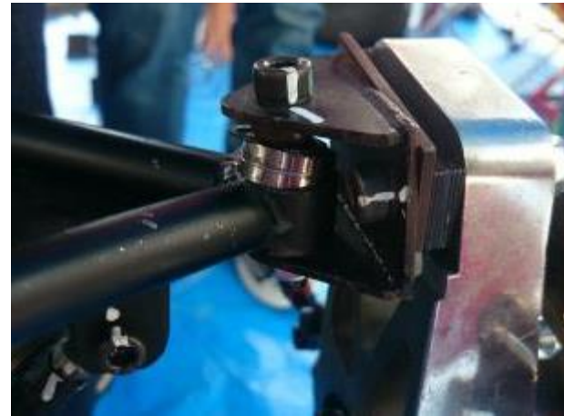
脱落しかけたベアリング
