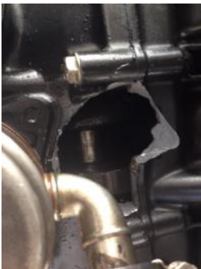
Fig.1 エンジン破損1
