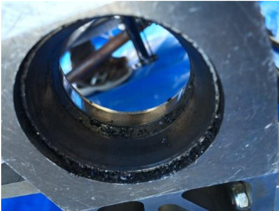
Fig.3 破損したハブベアリングアップライト側
