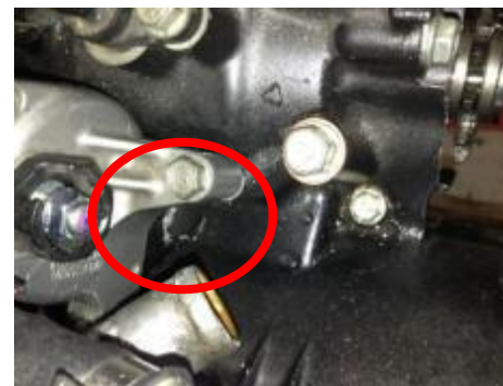
Fig.3 エンジン破損
