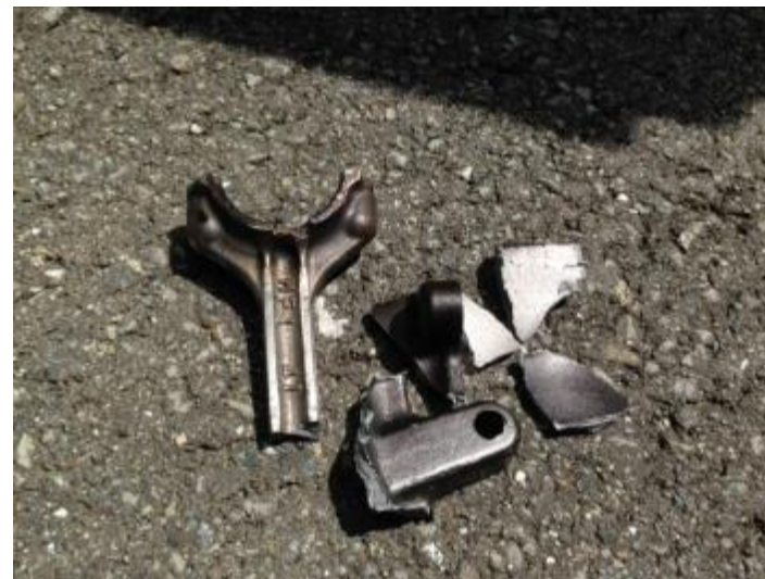
Fig.2 コンロッド破損
