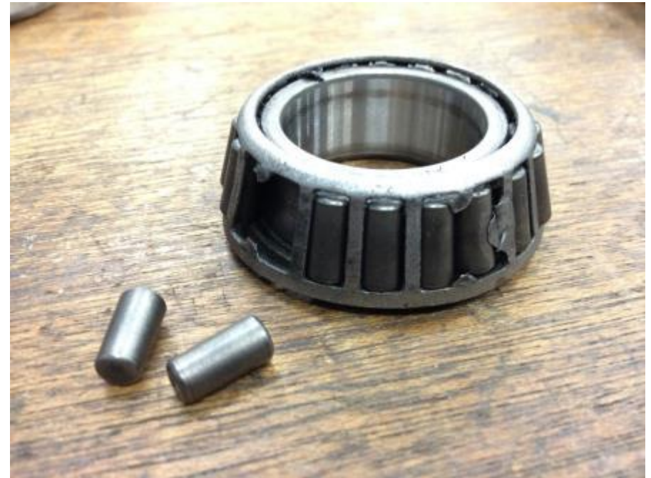
Fig.2 ーバートルクで締め付けられ 破損してしまったフロントハブベアリング
