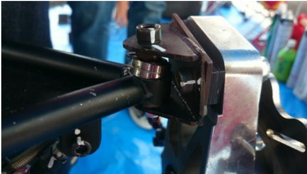
Fig.1 走行中に外れたロッドエンド
