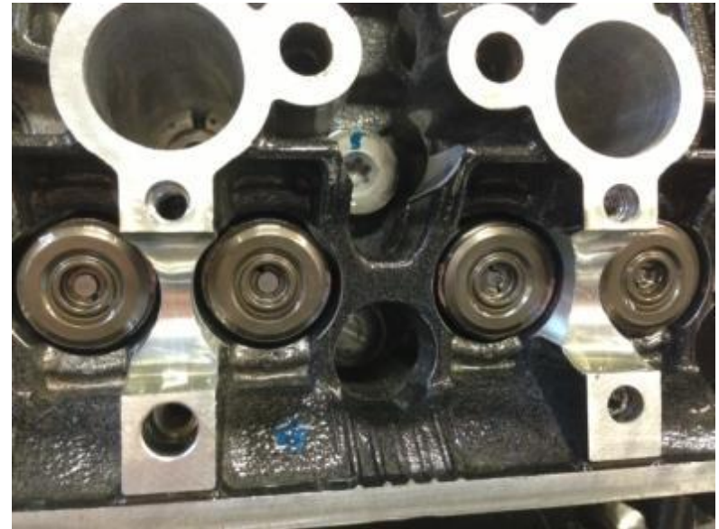
Fig.9 #3 気筒（正常）より#4 気筒（異常）の方が下がっている
