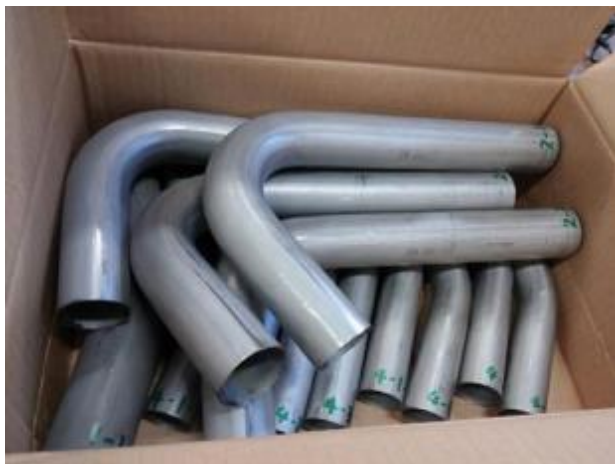
曲げ加工していただいたパイプ
