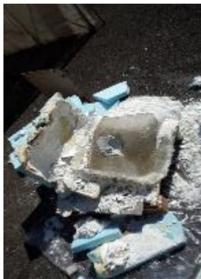
Fig.2 石膏型から離型したシート型
