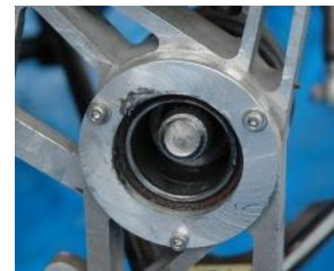
Fig.2 ねじ折れたドライブシャフト
