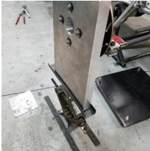
Fig.ダミーホイール搭載時のパンタジャッキ
