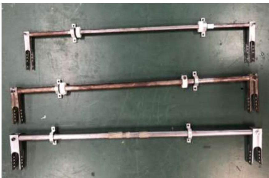
図2 アンチロールバー（上：フロント 中：旧リア 下：新リア）
