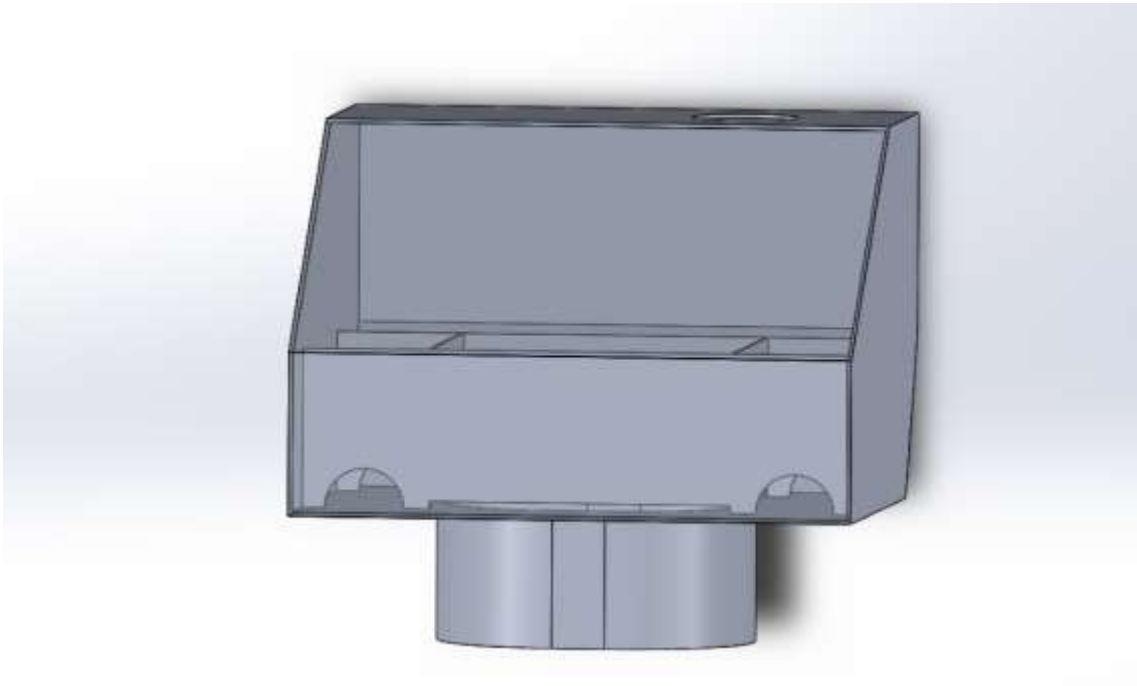
図5 模型に沿った燃料タンク設計
