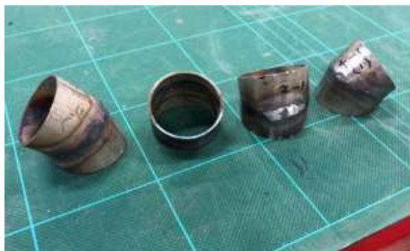
図1 ステンレスパイプのエキゾースト溶接
