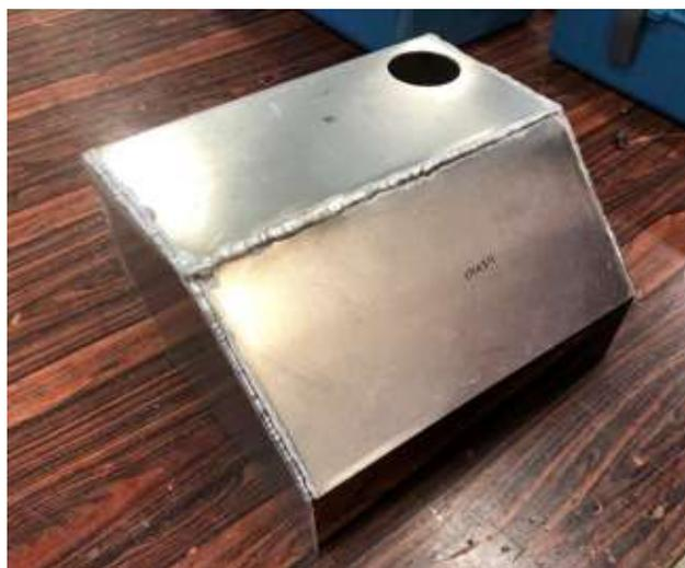
図2 製作した燃料タンク
