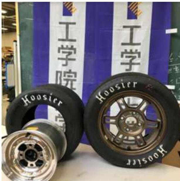
図3 10インチタイヤ（左）と13インチタイヤ（右）の比較
