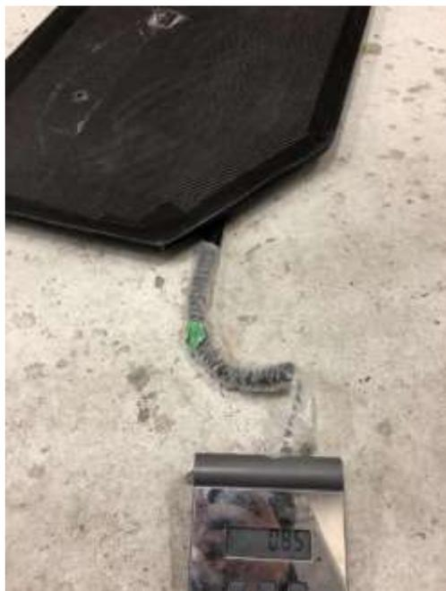
図16 18年度リアウイングの翼端板重量
