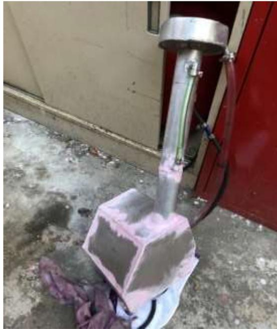
図3 燃料タンクの漏れ試験の様子
