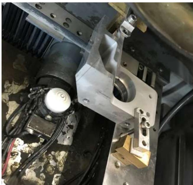
図6 ワイヤー放電加工の様子
