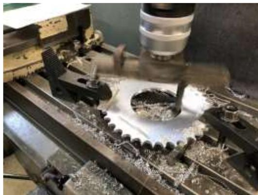
図4 スプロケットの中ぐり加工
