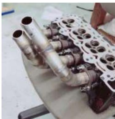
図2 パイプ集合部の溶接後
