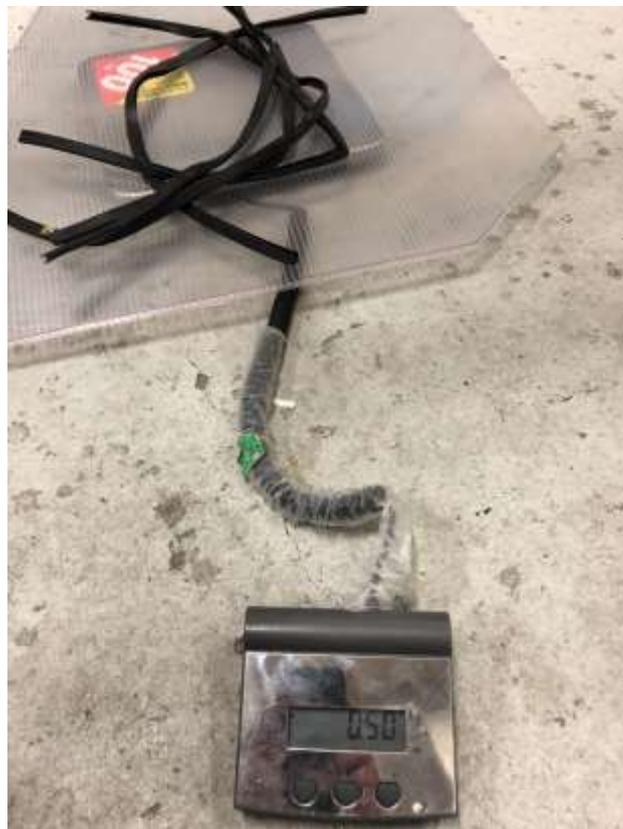
図 19 制作したリアウイング翼端板重量
