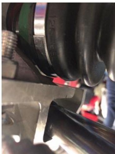
Fig.1 昨年度のドライブシャフトとアップライトの干渉のようす
