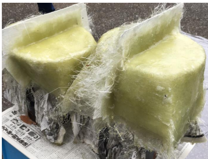
Fig.10 ラジエーターシュラウド FRP 積層
