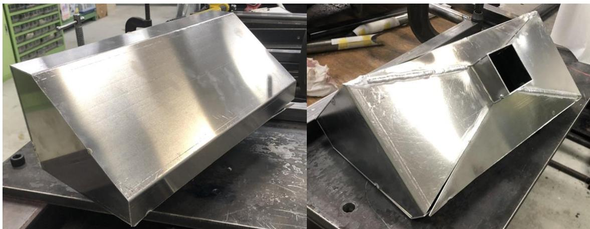
Fig.2 製作中の燃料タンク
