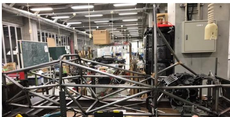
Fig. 9 製作中のフレーム
