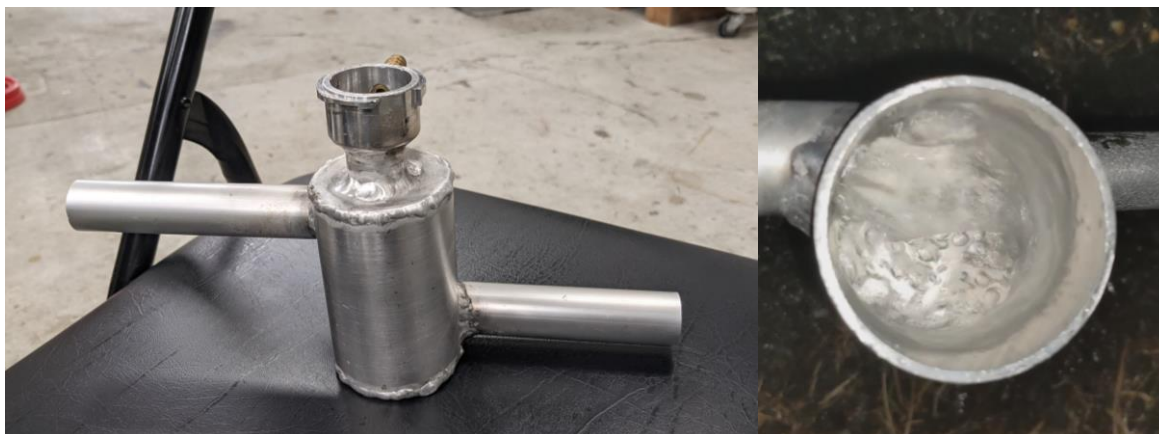
Fig.6 スワールポット、現物内部の流れの様子
