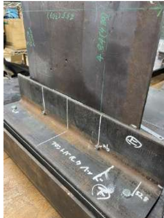
Fig.5 フロントバルクヘッド治具板取り付け図
