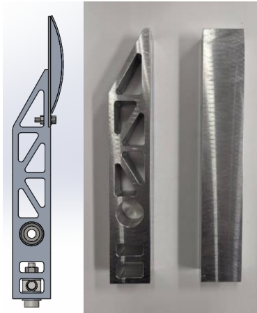
Fig. ペダル支柱 (左：設計 右：製作)
