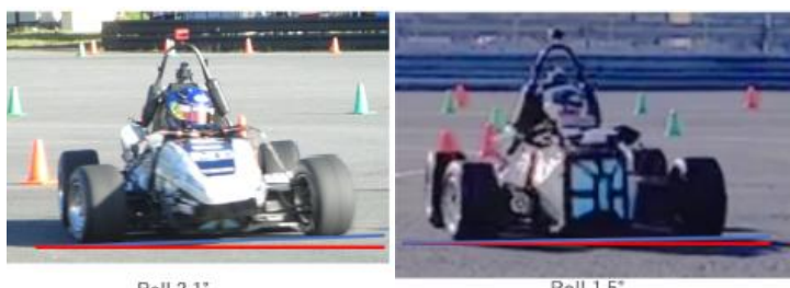
Fig. スタビライザー変更によるロール変化 (左:大会時 右:試走時)
