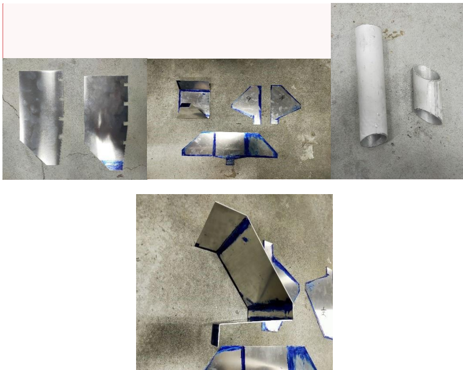
Fig. 燃料タンク アルミ切り出し
